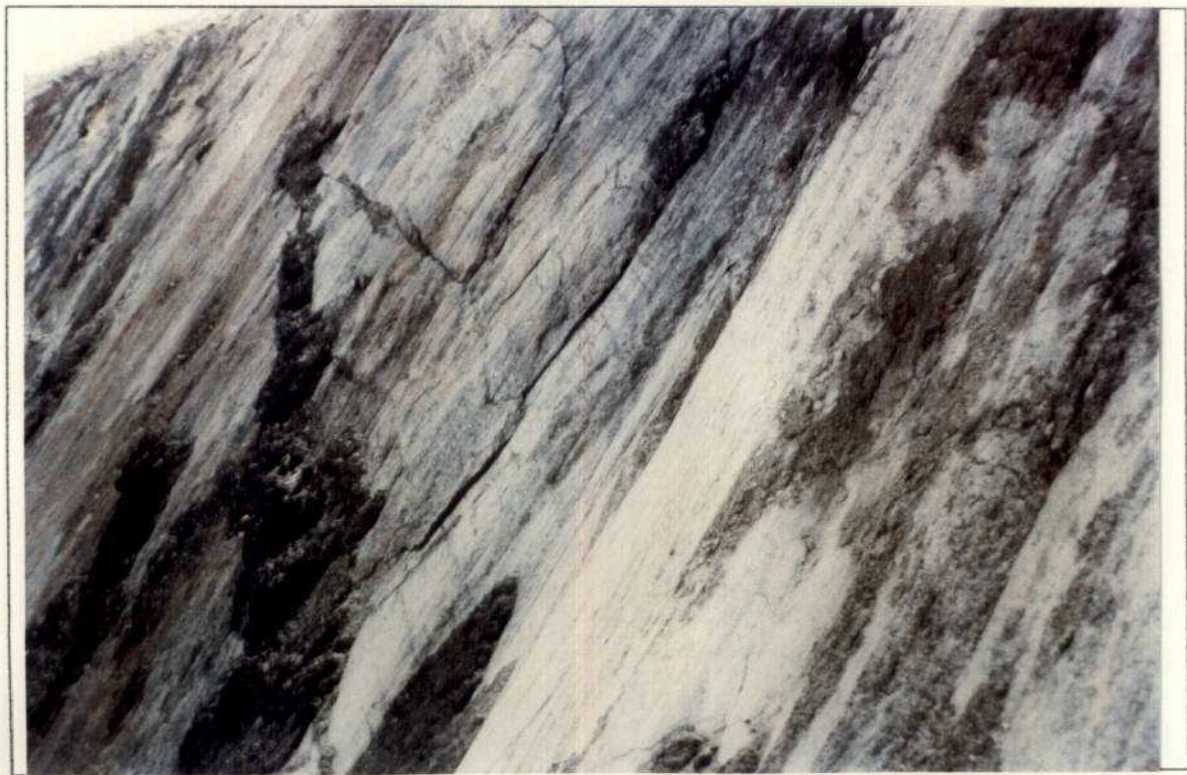
Fotografia-14:Detalle del plano de falla con estrías y escalones
